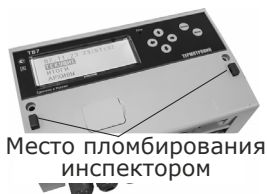
б) Пломба инспектора снабжающей организации
